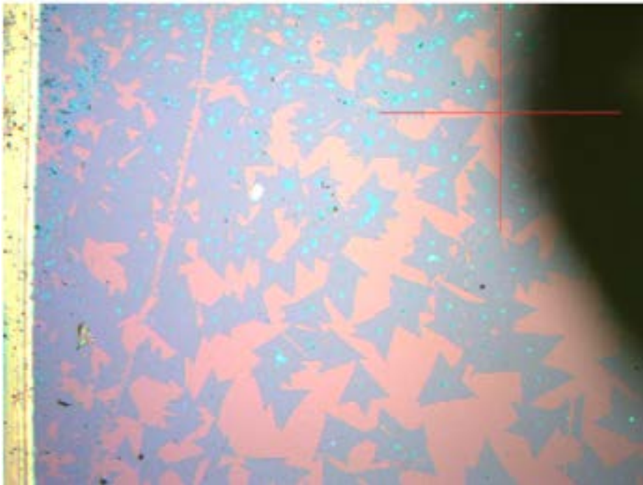
CVD grown MoS 2 on SiO 2 | MoS 2 déposé sur SiO 2 par exfoliation sous un microscope optique Sanmeet Chahal, Candidat pour la M. Sc. en physique | Candidate for Masters in Physics
